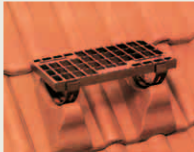
КЕРЕМИДА - ОСНОВА ЗА СЪТЪПАЛО, ДВОЙНО И ЕДИНИЧНО СЪТЪПАЛО Функционална и сигурна система за придвижване по покрива. Чрез добре съчетаните системни части се гарантира защита на покривната повърхност от проникване на дъждове. Керемидите-основа за стъпала се осигуряват допълнително с подсилена летва. Всяка основа е закрепена с два винта, размер 4,5 x 45 мм. Държачът свързва основата и стъпалата, регулирайки едновременно с това в съответствие с напасването наклона на покрива между 17° и 52°.
